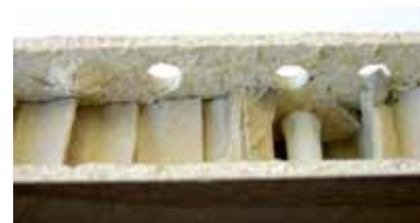
Bohrervergleich links: Standardbohrer rechts: Stehle VHW-Dübelbohrer
